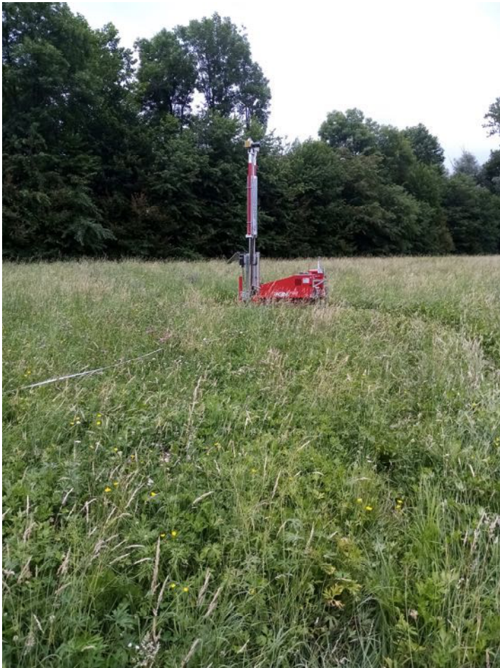
Foto n°2- Documentazione fotografica dell’indagine (prove penetrometriche dinamiche scpt)
