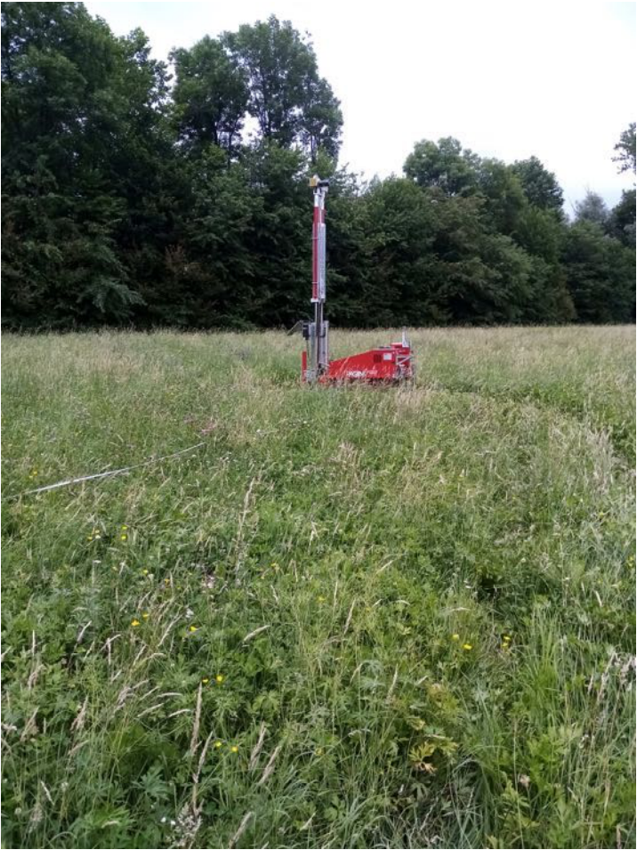
Foto n°2- Documentazione fotografica dell'indagine (prove penetrometriche dinamiche scpt)
