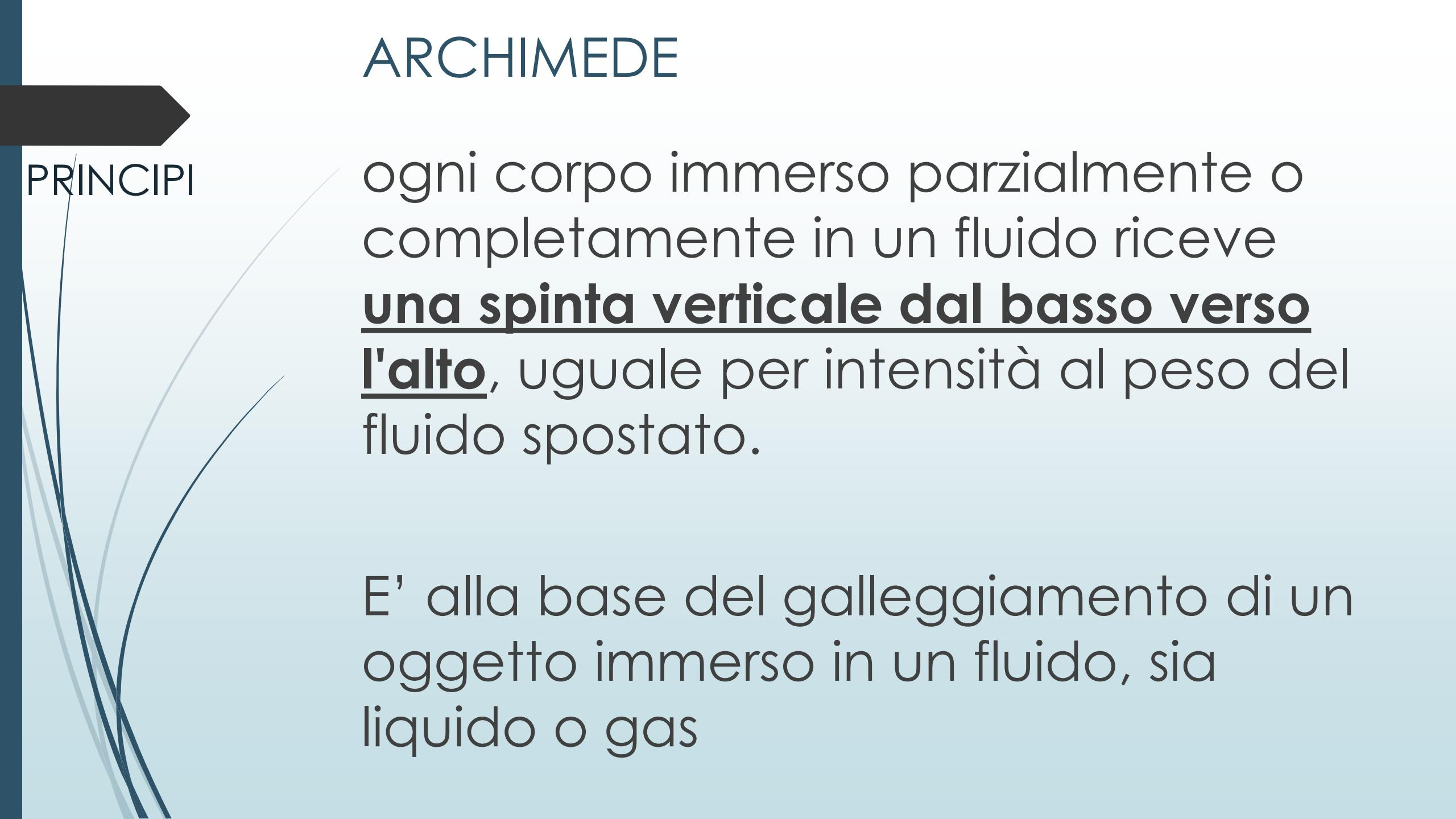
ogni corpo immerso parzialmente o completamente in un fluido riceve **una spinta verticale dal basso verso l'alto**, uguale per intensità al peso del fluido spostato.
