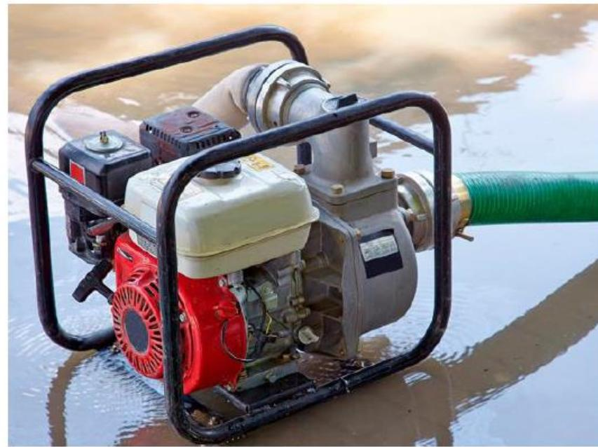
Una valvola di non ritorno (clapet – ritegno) incorporata nel corpo evita lo svuotamento di quest'ultimo alla fermata della pompa, permettendo un rapido innescamento alla ripartenza della pompa.
